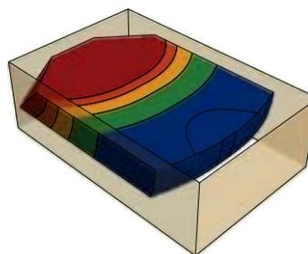
Sensación de calor con calefacción en un lateral (formato 6 x 4 m)
