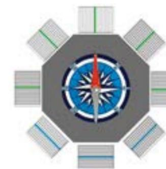
■ E-NE-N-NO-O: lamas perpendiculares a la fachada. ■ SO-S-SE: lamas paralelas a la fachada.
