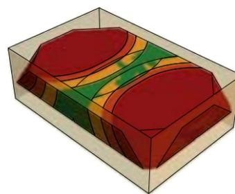
Sensación de calor con calefacción en dos laterales (formato 6 x 4 m)
