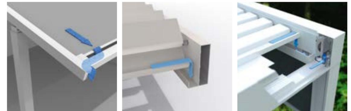
Lapure soporta una intensidad de precipitación de 50 l/m<sup>2</sup> h durante un máximo de dos minutos. Cuando llueve con intensidad, el agua se evacúa por la barra de contrapeso. Las lluvias torrenciales pueden formar bolsas de agua, aunque el toldo puede seguir recogiendo así.
