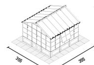
Invernadero con cubierta de policarbonato, 1 puerta y 1 ventana con ventanaje lateral de policarbonato
