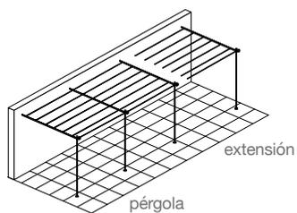
Las medidas indicadas en los dibujos se refieren al estorbo máximo. La decoración de las vigas sobresale respecto a los pilares de aprox. 20,5 cm en las pérgolas adosadas, y de 18,5 cm en las pérgolas autoportantes.
