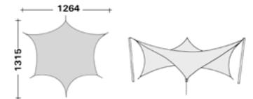
Vela hexagonal con cables, tirantes, picas tensoras y 3 postes de apoyo de madera laminar 9 x 9 A. 400
