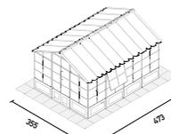
Invernadero con cubierta de policarbonato, 1 puerta y 1 ventana con ventanaje lateral de policarbonato
